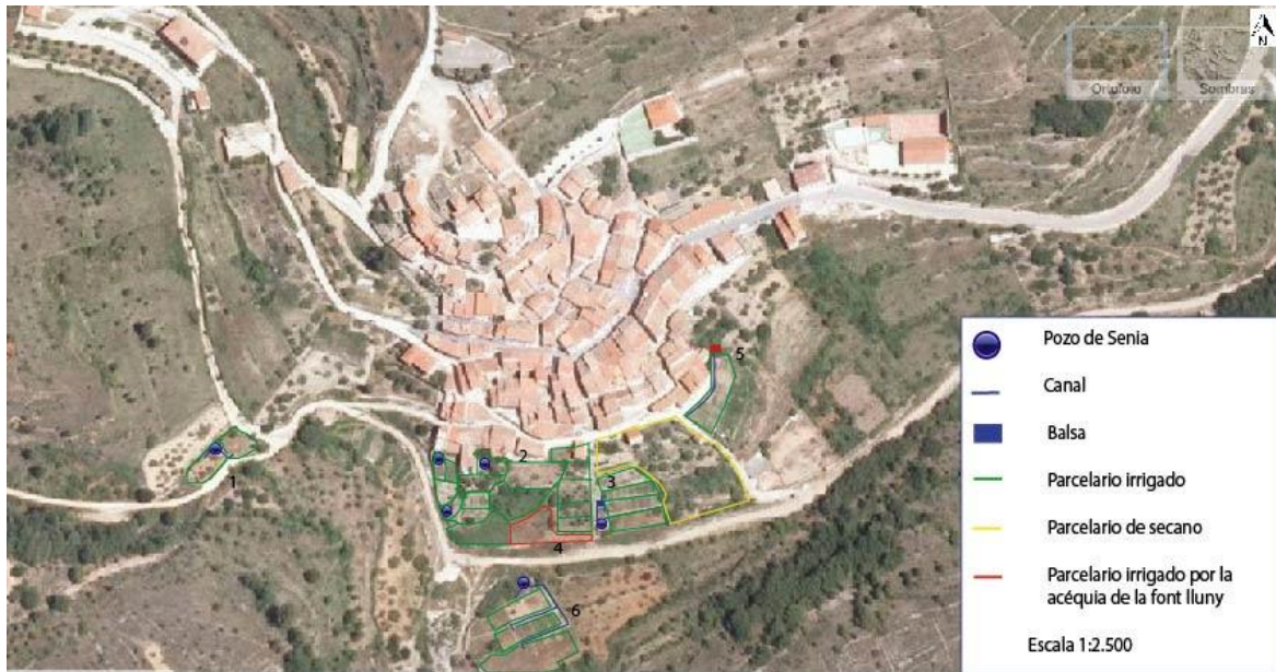
Fig. 14. Parcelario y sistemas de riego de la partida de Davall la vila de La Pobla de Benifassà
