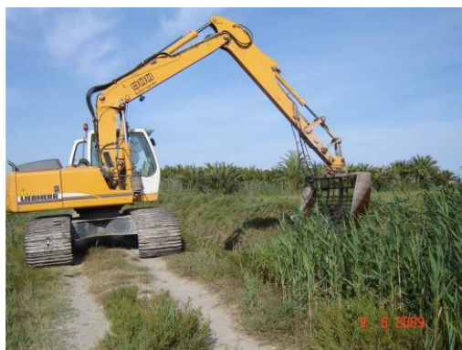
Fig. 9. La máquina utilizada para realizar las mondas de azarbes en Carrizales con el menor daño ecológico, invento de nuestros comuneros.
